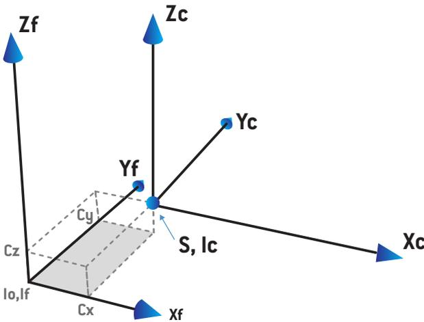
**Figure 7.** Illustration de la position de la source où  $I_o$  = Isocentre,  $S$  = Source,  $c$  = CyberKnife système de coordonnées de la source de rayonnement et  $f$  = système de coordonnées fixes.
