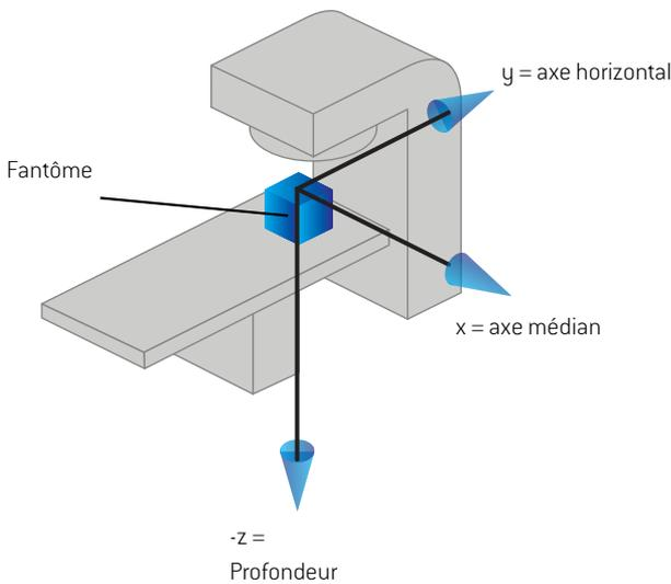
**Figure 8.** Système de coordonnées du profil de dose.
