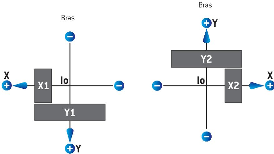
**Figure 6.** Positions du collimateur en Beam's eye view, selon la norme non IEC (Varian Standard). Remarque : les coordonnées visualisées en Beam's eye view sous RayPlan utilisent toujours le système de coordonnées IEC 61217.
